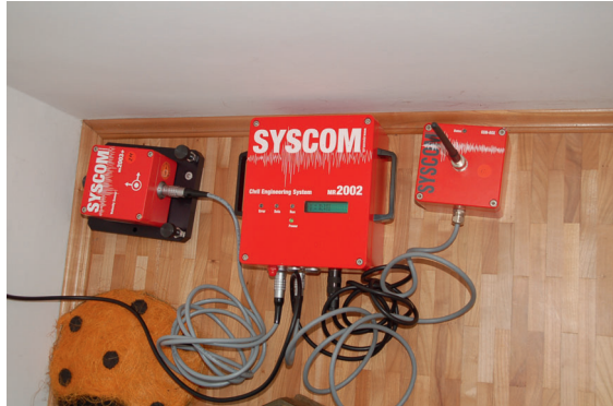
Abb. 3.6.4-6 Messeinrichtung mit Sensor, Aufzeichnungs- und Sendeeinheit, Hersteller Syscom Instruments SA, Schweiz (Quelle: R. Schöwer)
